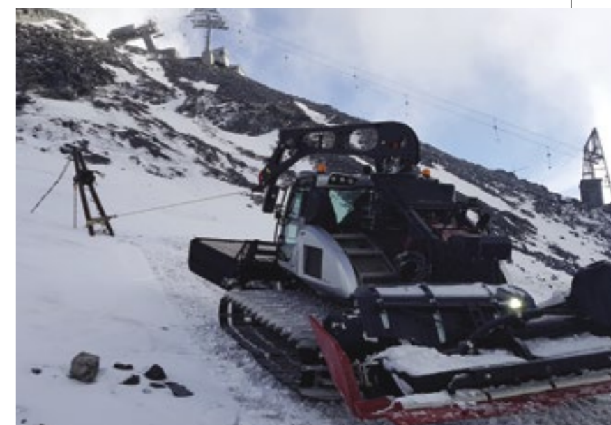
↑ Il Leitwolf in azione ← Il display di comando del sistema Snow How ↓ L'agganciamento del cavo del vericello al supporto fissato nella roccia e nel ghiaccio
