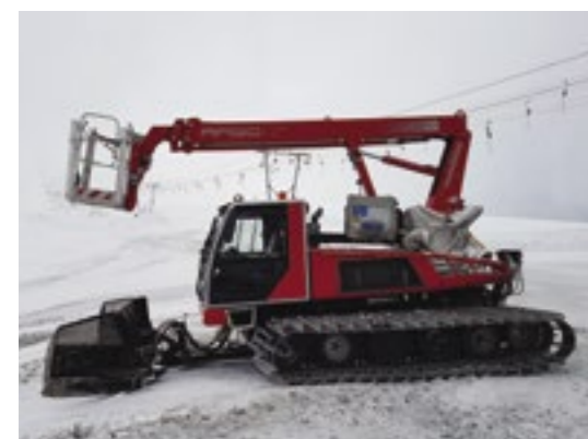
← Allestimento speciale di un mezzo di servizio per gli interventi sulle linee aeree
