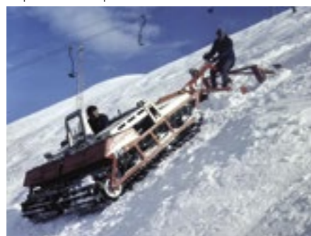
P 15 con il primo prototipo di piastra battipista nel 1972
